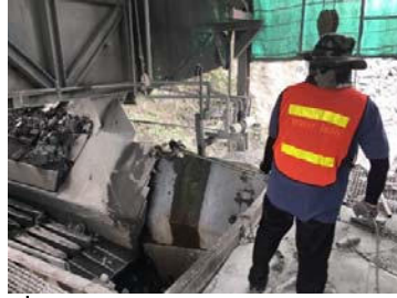
รูปที่ 3-28: การตรวจวัดค่าความทึบแสง บริเวณปากโม่แรก
