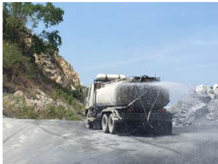
รูปที่ 2-13: การฉีดพรมน้ำบริเวณหน้าเหมือง
